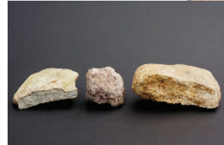
links: Oberer Stubensandstein, kalkgebunden mit spiegelnder Fläche mitte: Kalkmergelknolle; rechts: Oberer Stubensandstein mit Rostflecken
